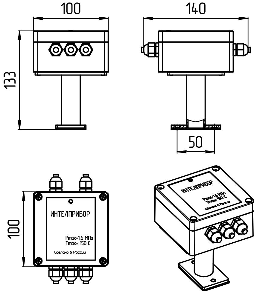
Рис6. Измерительный модуль М021
