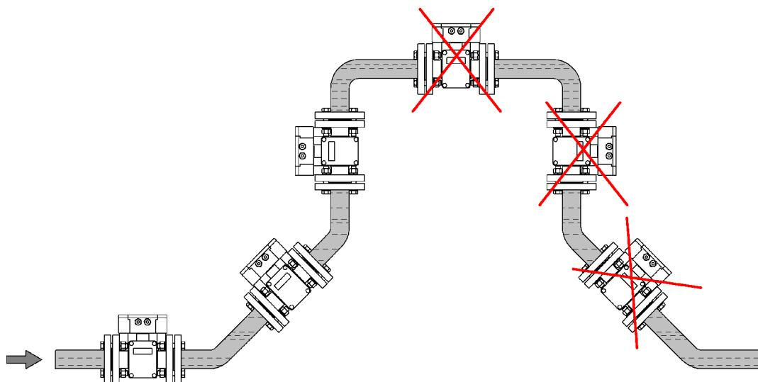
При необходимости подъема трубы (например, в случае расположения трубопровода вблизи пола), рекомендуется устанавливать ИМ на восходящем участке так, чтобы точка перелива в верхнем участке трубопровода находилась выше внутреннего проточного пространства расходомера, что обеспечит его заполнение независимо от скопления воздуха:
