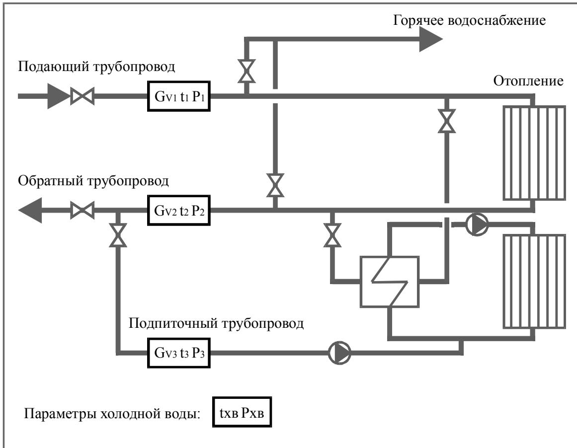
Рис16. Общая схема узла учета у потребителя тепла
