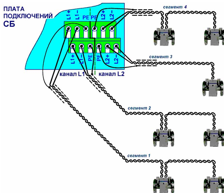
Рис13. Схема подключения ИМ к СБ МКТС
