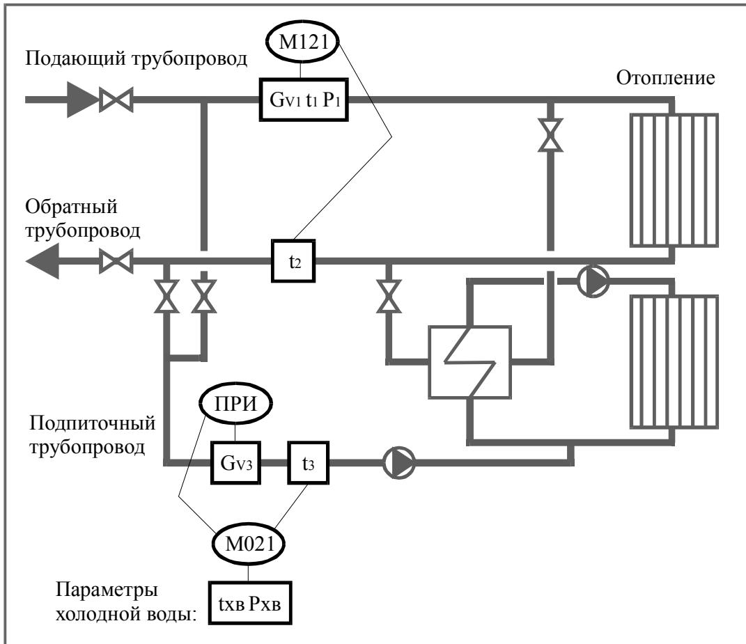
Рис26. Пример установки ИМ для схемы учета «Закрытая»
