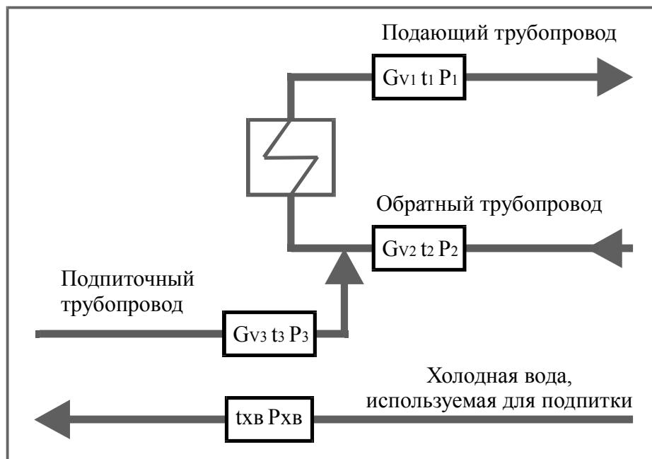
Рис17. Общая схема узла учета на источнике тепла
