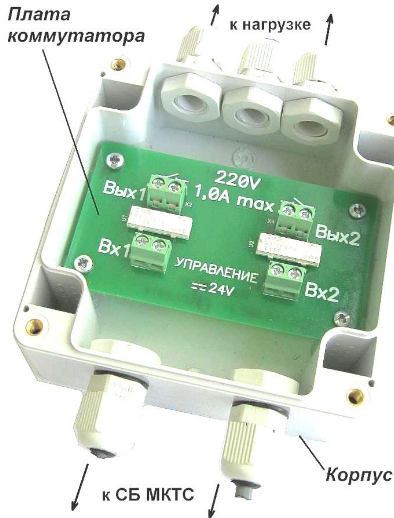
Рисунок 10.5. Внешний вид коммутатора (крышка корпуса снята).
