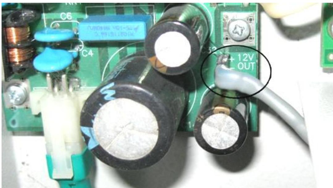
Рисунок 12.5. Подключение кабеля питания к ИП производства Интелприбор.
