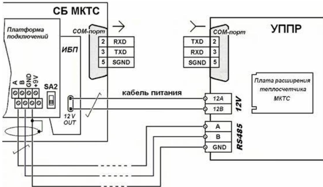
Рисунок 12.3. Схема подключения УППР к СБ-04 через интерфейс RS485.
