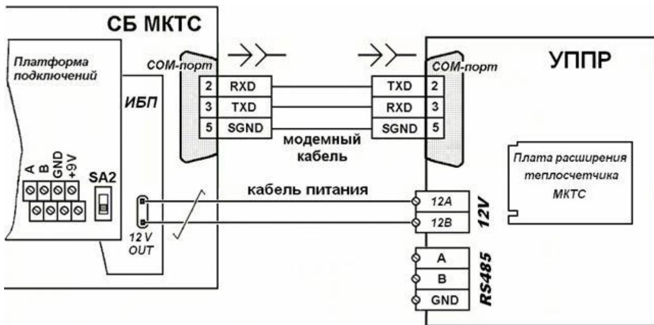
Рисунок 12.2. Схема подключения УППР к СБ-04 через СОМ-порт.
