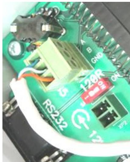
Рисунок 12.4. Подключение линии связи интерфейса RS-485.
