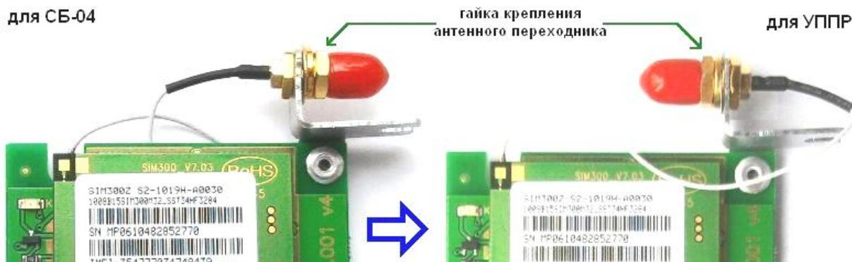
Если разъем антенного переходника на плате GSM модема находится в положении, указанном на рисунке слева, то для установки в УППР его необходимо переставить в положение изображенное на рисунке справа (в этом положении стенка корпуса УППР не будет мешать завинчиванию разъема антеннны в разъем антеннного переходника).
