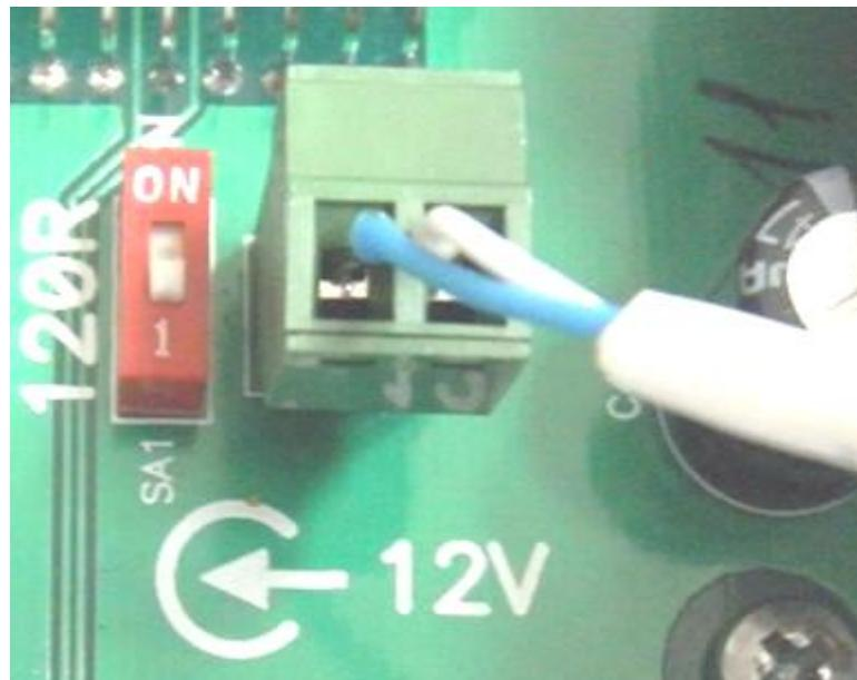
Рисунок 12.6. Подключение питания к плате УППР.
