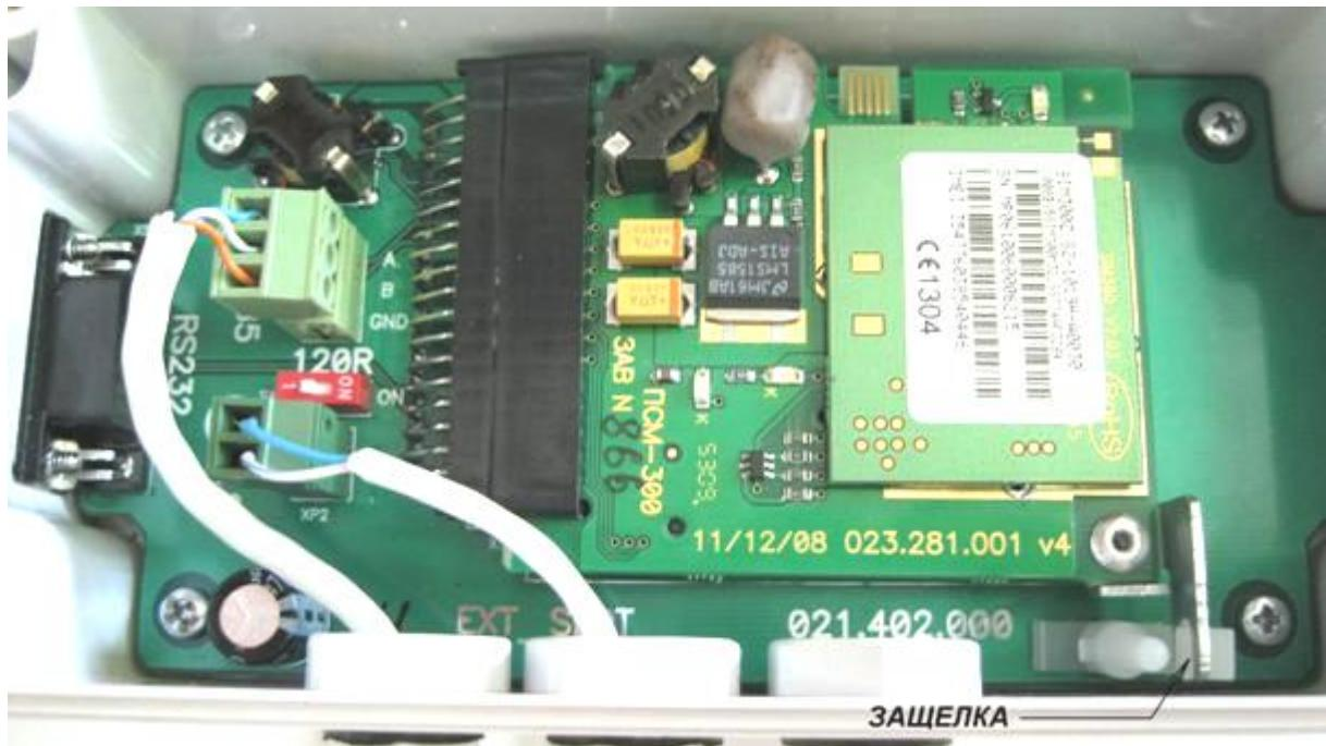
Рисунок 12.8. Фиксация ПР теплосчетчика МКТС в УППР.
