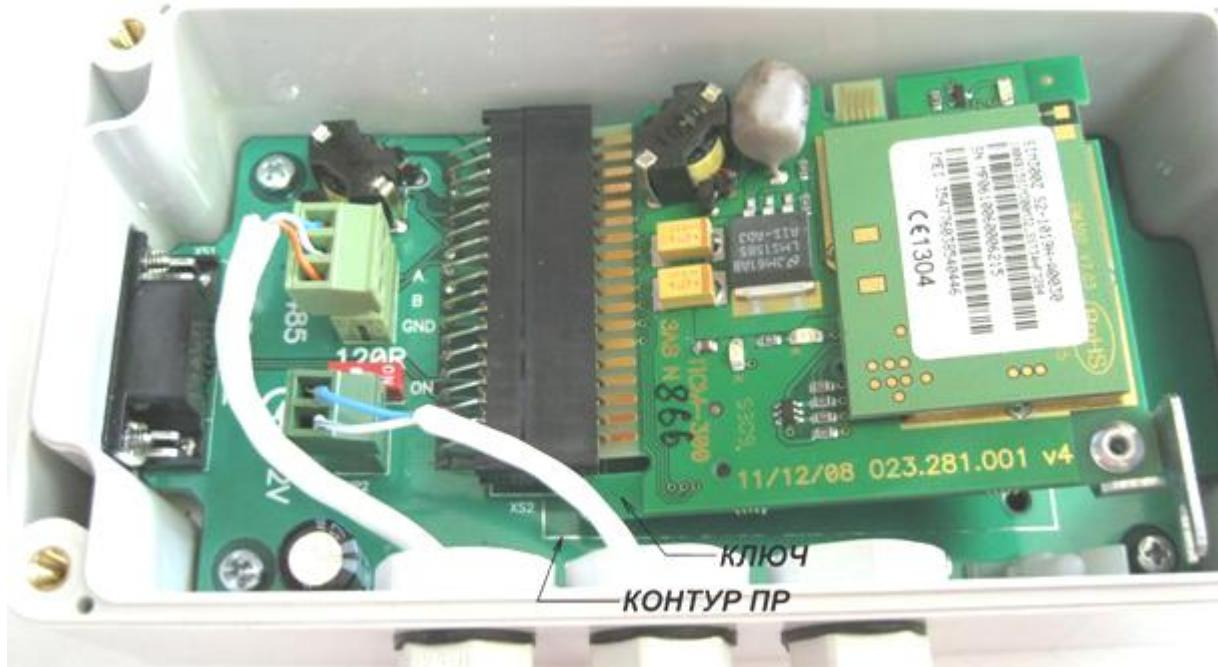
Рисунок 12.7. Установка ПР теплосчетчика МКТС в УППР.
