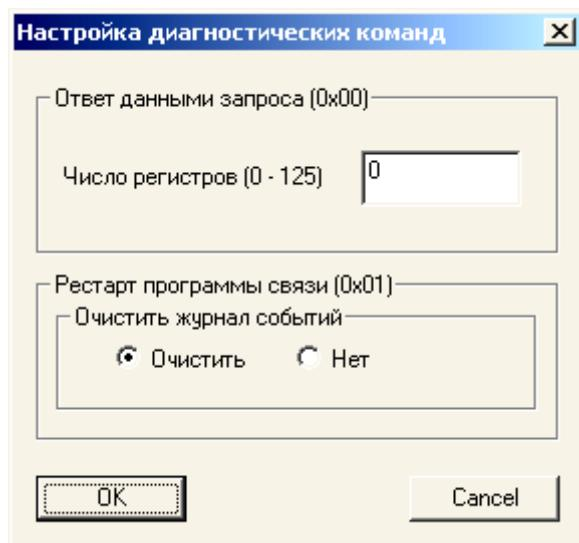
Рисунок 4.9 Настройка параметров некоторых диагностических команд.
