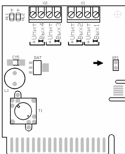
Рисунок 7.6 Расположение перемычки разрешения сохранения настроек ПТВ.
