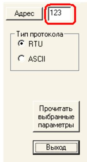
Рисунок 4.4 Настройка адреса в сети MODBUS.
