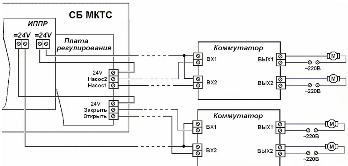
Рисунок 10.6. Схема подключения коммутатора.
