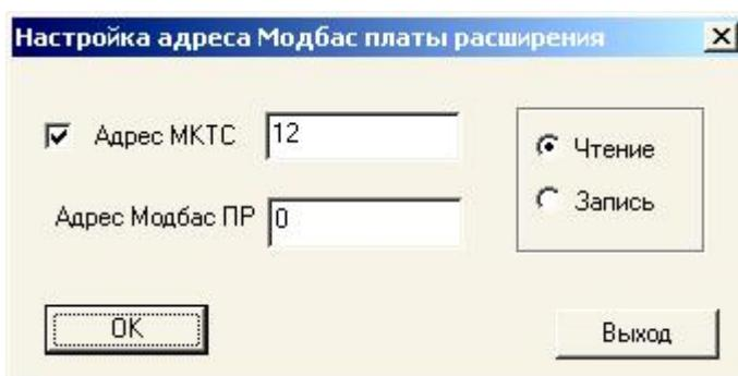
Рисунок 4.6 Настройка адреса МКТС в сети MODBUS.
