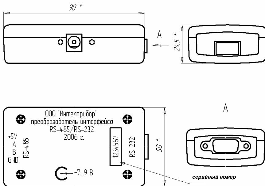
Рисунок 5.1 Габаритные размеры преобразователя интерфейса RS-485/RS-232
