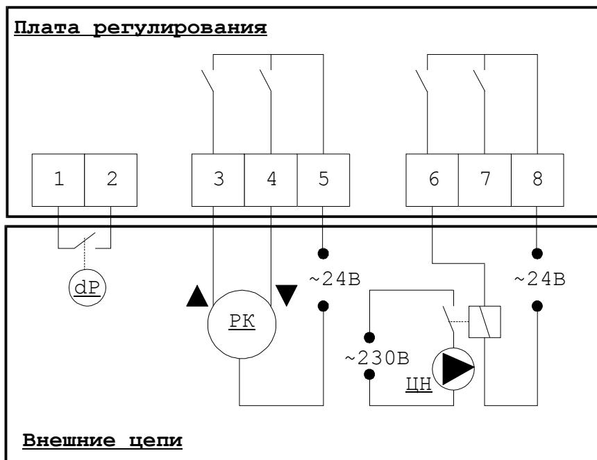
Рисунок 10.3. Схема подключения платы регулирования.
