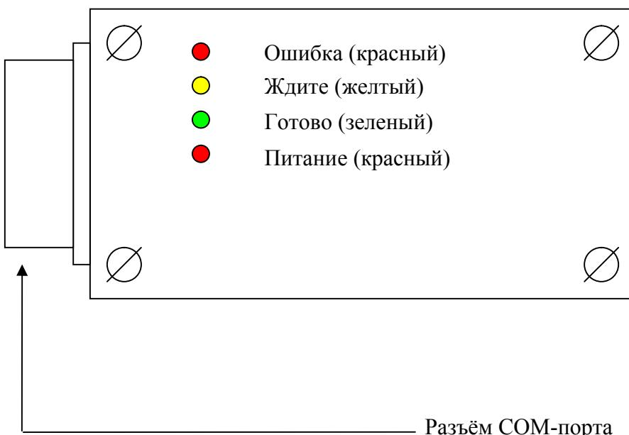
Рисунок 9.1. Внешний вид модуля переноса данных.
