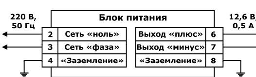
Рисунок 12 - Защитное заземление
