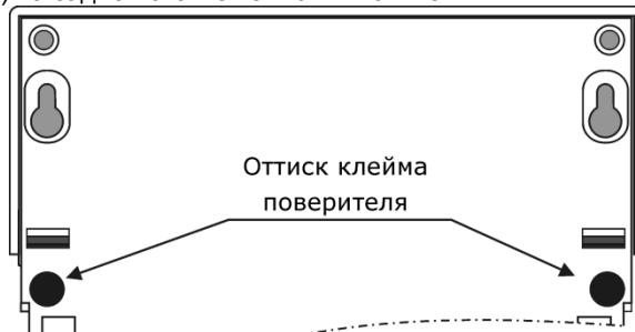
Рис. 1.2 – Места пломбирования поверителем
