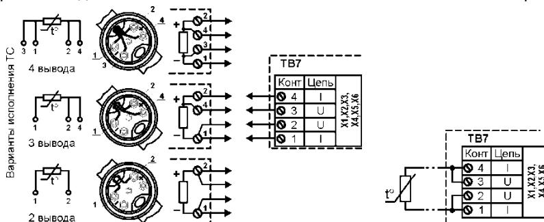
а) Подключение ТС по 4-проводной схеме
