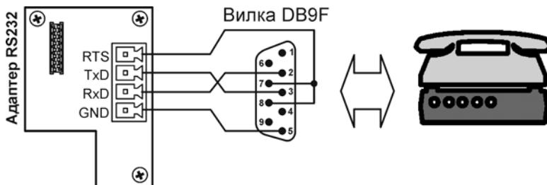
**Примечание** Для нормальной работы интерфейса RS232 на контакте RTS адаптера должен присутствовать сигнал постоянного уровня с напряжением +5,5...12В от ПК или модема.
