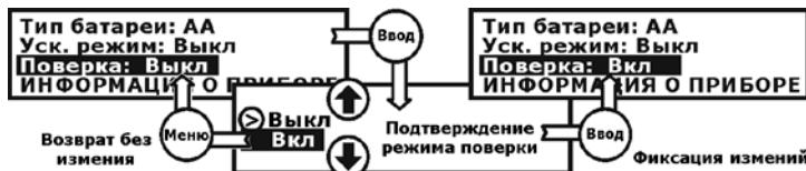
Рис. 3.13 – Включение режима поверки
