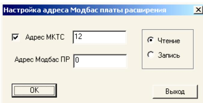
Рисунок 4.6 Настройка адреса МКТС в сети MODBUS.
