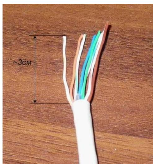
Рисунок 12.1 Снятие внешней оболочки с кабеля.
