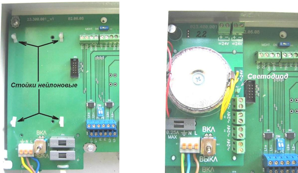
Рисунок 10.4. Установка ИП платы регулирования в корпус СБ МКТС.
