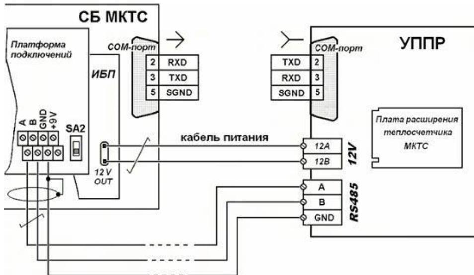
Рисунок 14.3. Схема подключения УППР к СБ-04 через интерфейс RS485.
