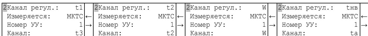
Приведенная в примере настройка соответствует схемам В) и Г) из рассмотренных выше схем тепловых пунктов. Измеряемые параметры регулятора G1c, t1c, G2c, t2c и W для любых схем тепловых пунктов соответствуют указанным в примере каналам узла учета теплосчетчика (Gv1, t1, Gv2, t2 и W).
