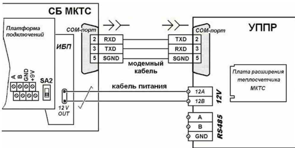
Рисунок 14.2. Схема подключения УППР к СБ-04 через СОМ-порт.
