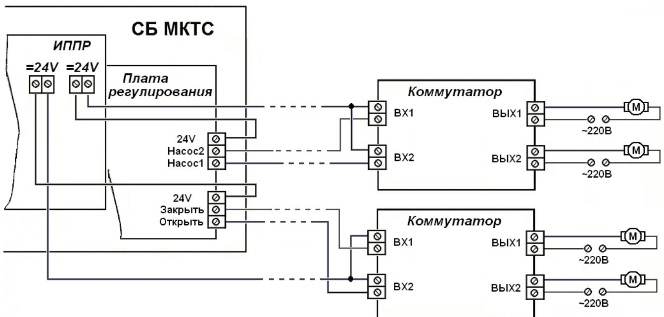
Рисунок 10.6. Схема подключения коммутатора.
