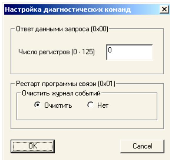
Рисунок 4.9 Настройка параметров некоторых диагностических команд.
