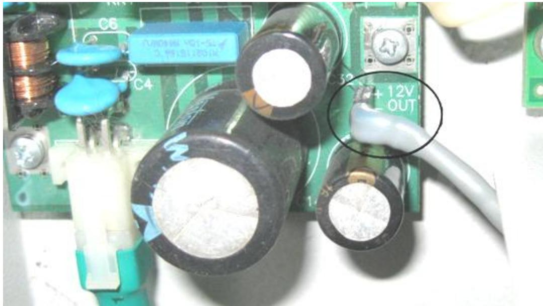
Рисунок 14.5. Подключение кабеля питания УППР к разъему блока питания СБ
