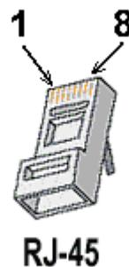
Рисунок 12.2 Нумерация выводов вилки RJ-45
