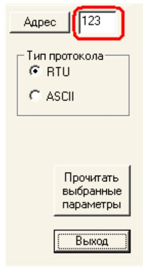
Рисунок 4.4 Настройка адреса в сети MODBUS.
