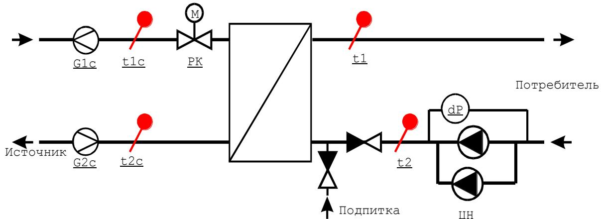
**Б) Тупиковая схема системы ГВС.** Отличается от предыдущей отсутствием циркуляции во вторичном контуре. В этой схеме необходимо обеспечить корректное измерение температуры  $t_1$  при минимальном или отсутствующем расходе воды в системе ГВС:
