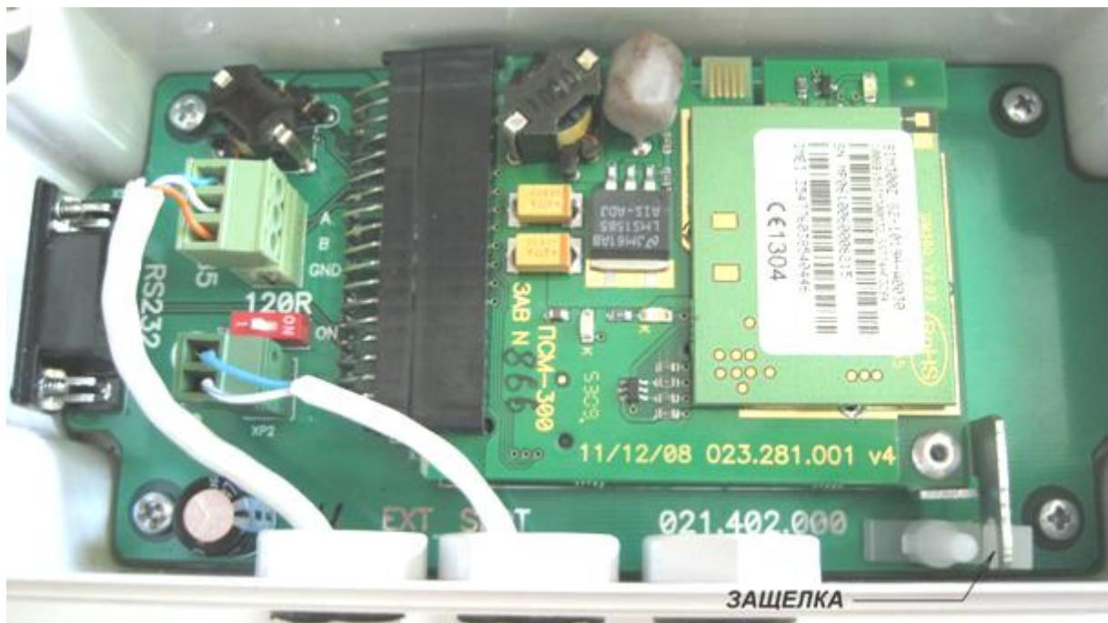
Рисунок 14.8. Фиксация ПР теплосчетчика МКТС в УППР.
