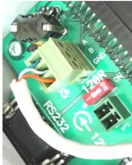
Рисунок 14.4. Подключение к УППР линии связи интерфейса RS-485
