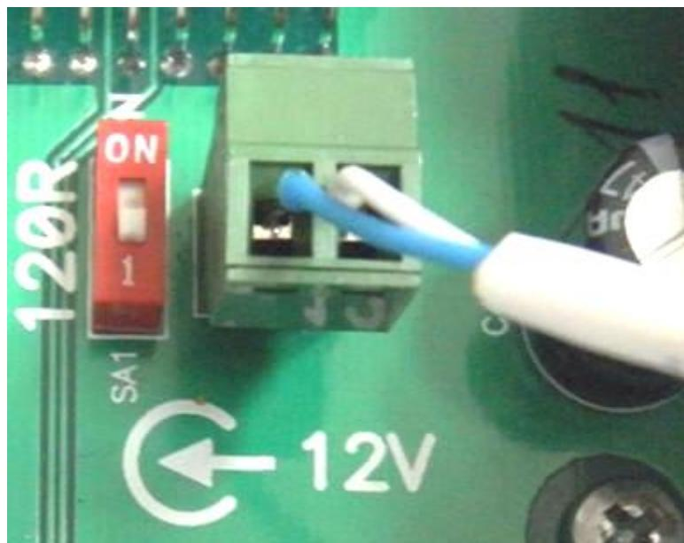
Рисунок 14.6. Подключение питания к плате УППР.
