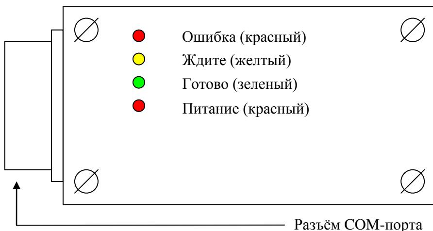
Рисунок 9.1. Внешний вид модуля переноса данных.
