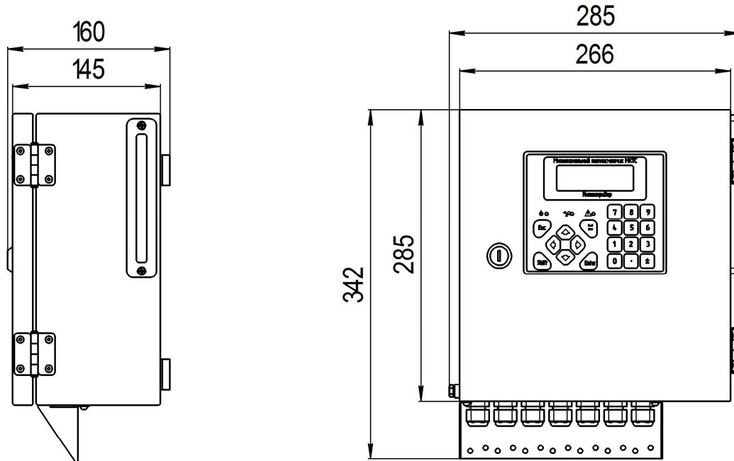
Рис1. Общий вид и габаритные размеры СБ-04
