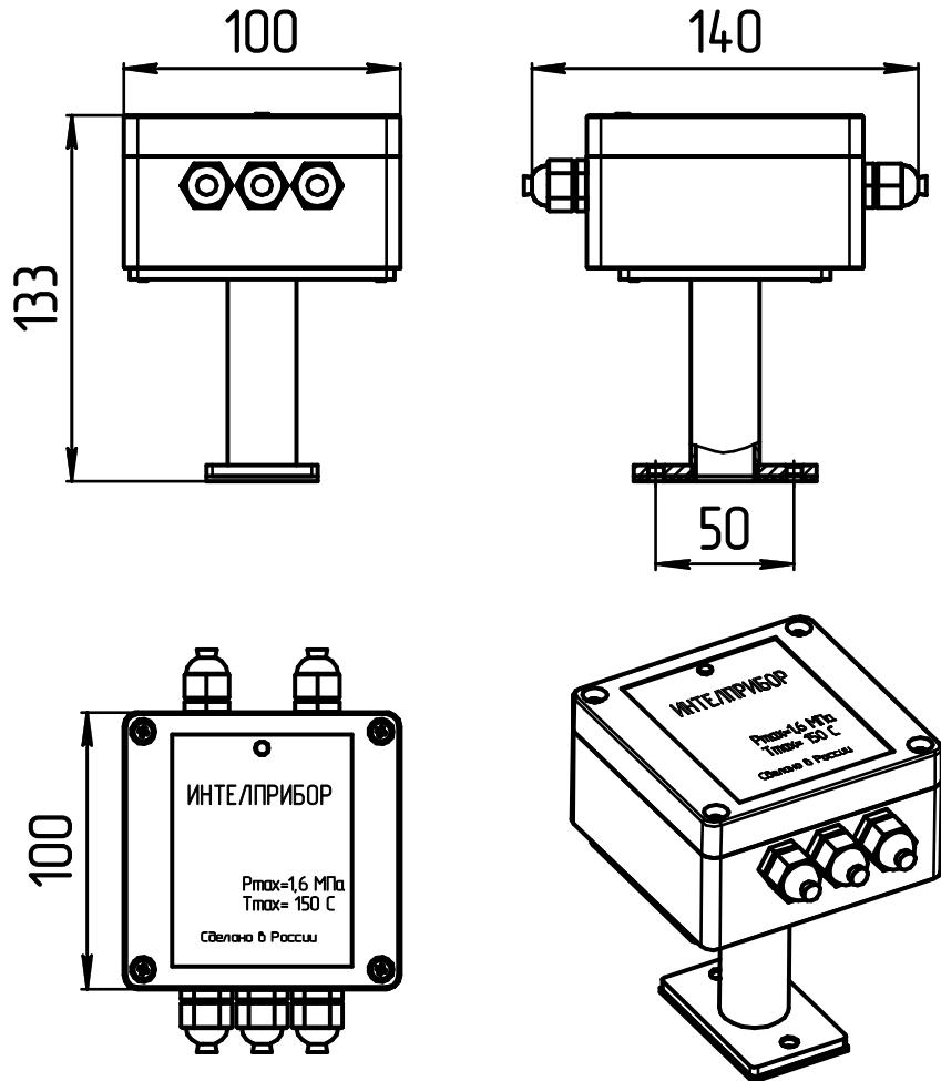
Рис6. Измерительный модуль М021
