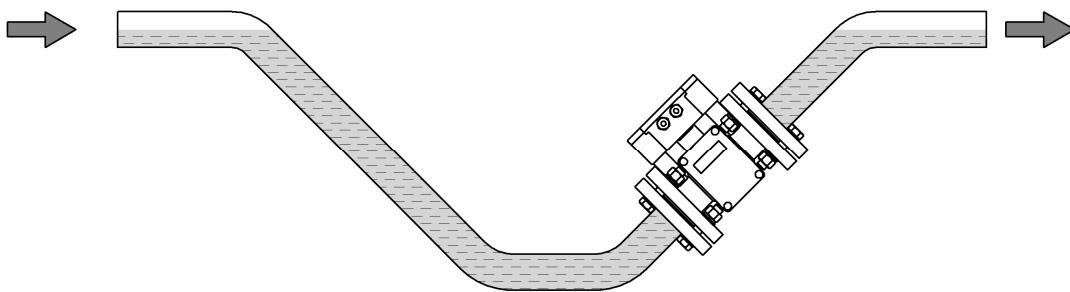
Принципиально важно при установке ИМ согласовывать направление стрелки на его боковой поверхности с нормальным направлением потока измеряемой среды. В противном случае ИМ с преобразователем расхода будет фиксировать отрицательный расход.
