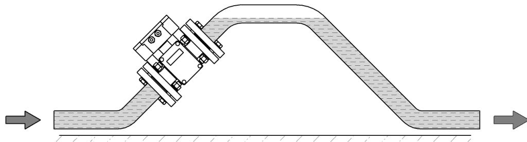
В случае невозможности установки ИМ в рекомендуемых местах **допускается, как исключение**, монтаж в верхней точке системы. При этом необходимо предусмотреть установку автоматического воздушного клапана (автоматического воздухоотводчика) для выпуска воздуха в атмосферу. Необходимо также обеспечить периодическую (не реже раза в неделю) проверку работоспособности клапана. Входное отверстие для отвода воздуха через клапан должно располагаться выше верхней точки проточной части расходомера:
