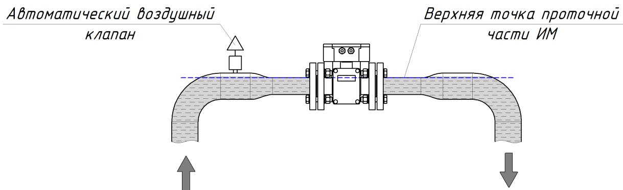
При измерении расхода в частично заполненном трубопроводе или в трубопроводе с открытым концом, ИМ следует устанавливать на наклонном восходящем участке трубопровода:
