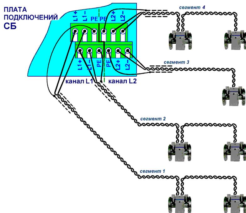
Рис13. Схема подключения ИМ к СБ МКТС
