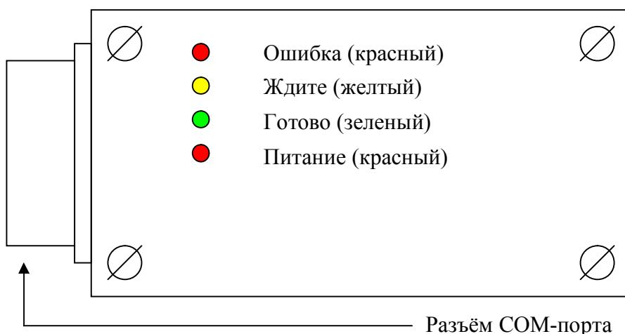
Рисунок 9.1. Внешний вид модуля переноса данных.
