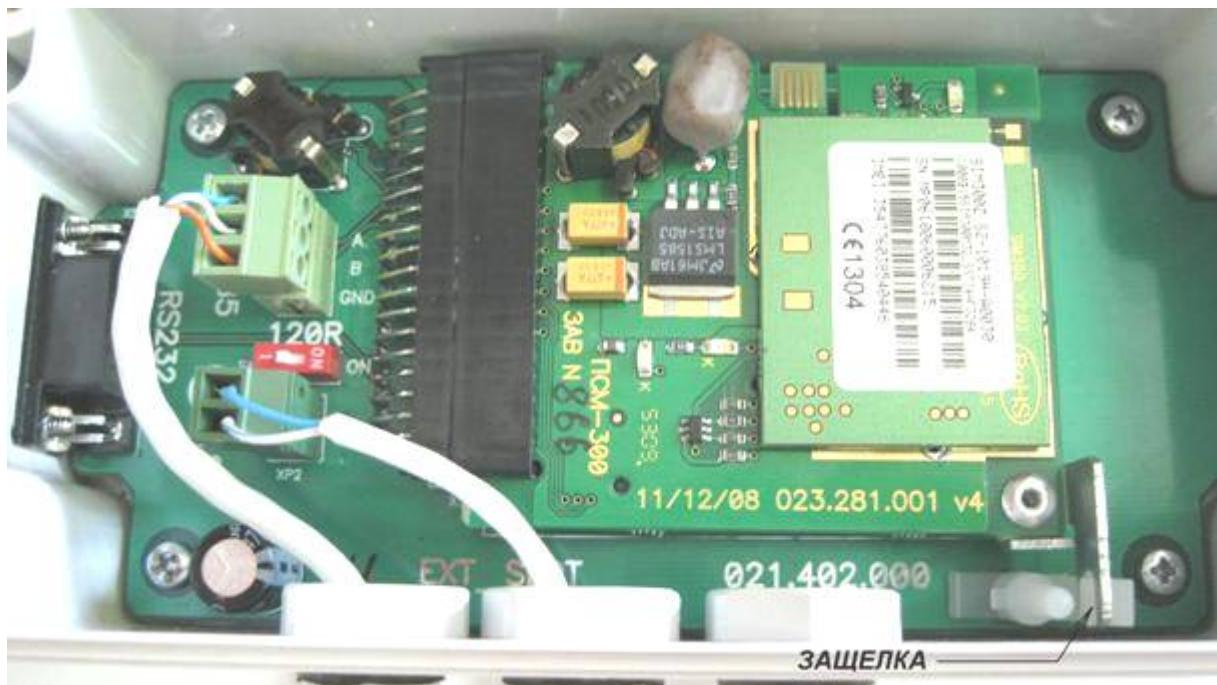
Рисунок 14.8. Фиксация ПР теплосчетчика МКТС в УППР.
