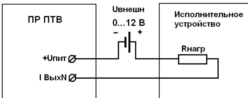
Рисунок 7.3 Подключение исполнительного устройства к токовому выходу с использованием дополнительного внешнего источника питания.
