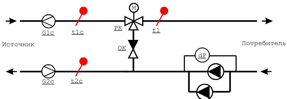
**Г) Зависимая схема системы отопления или ГВС с двухходовым регулирующим клапаном.** Такая схема имеет меньшую эффективность по сравнению с предыдущей и может
