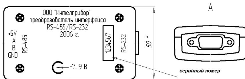
Рисунок 5.1 Габаритные размеры преобразователя интерфейса RS-485/RS-232
