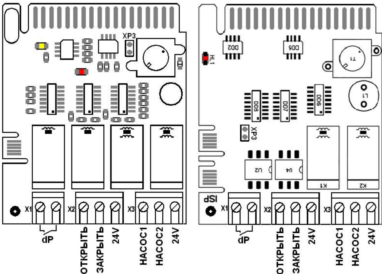
Рисунок 10.2. Внешний вид платы регулирования (v2 и v3).
