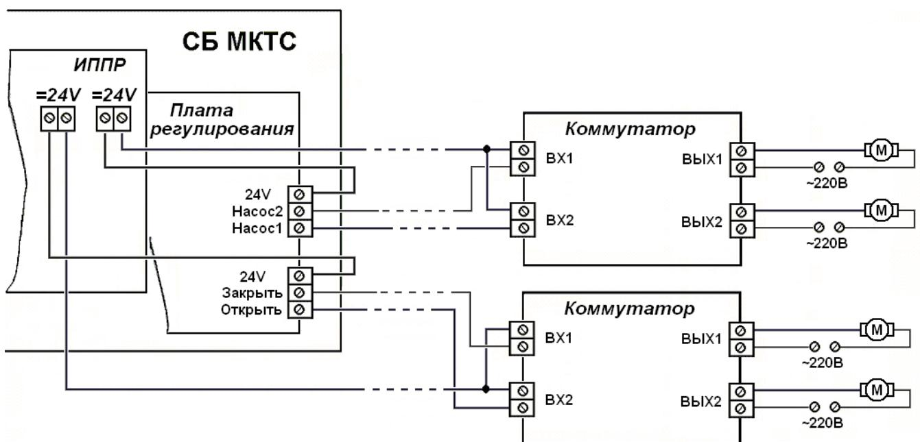
Рисунок 10.6. Схема подключения коммутатора.
