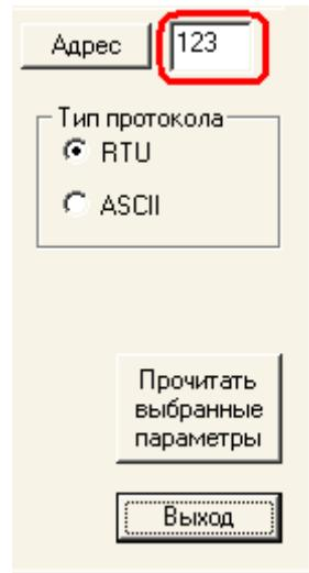
Рисунок 4.4 Настройка адреса в сети MODBUS.
