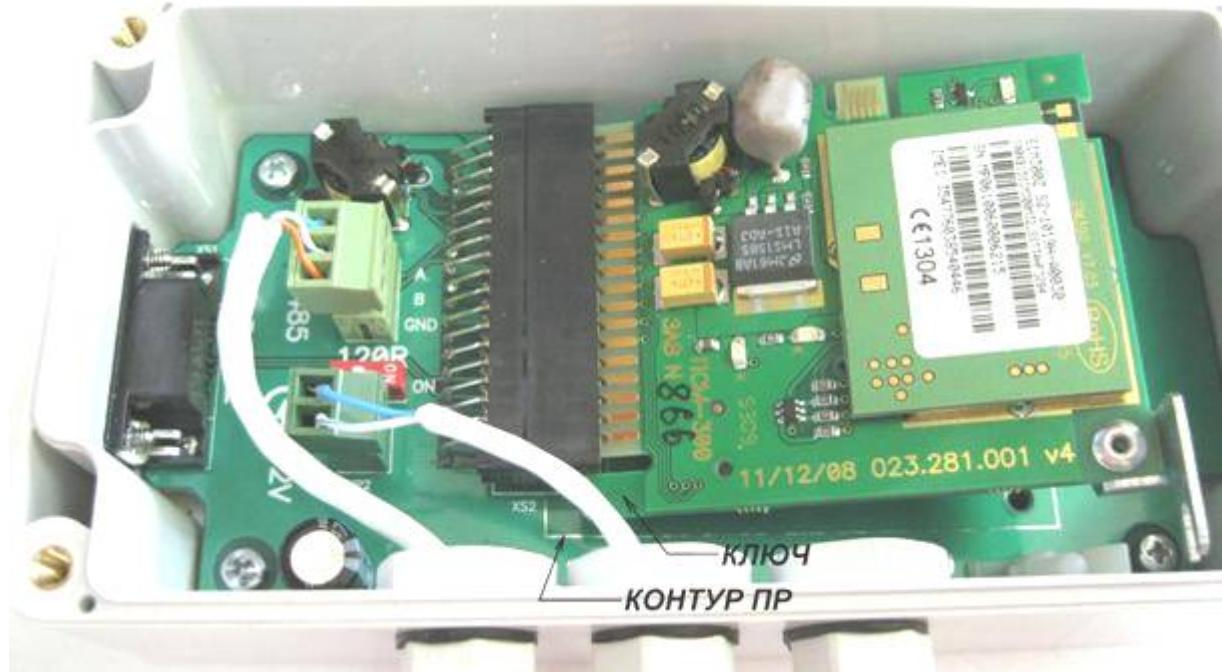
Рисунок 14.7. Установка ПР теплосчетчика МКТС в УППР.
