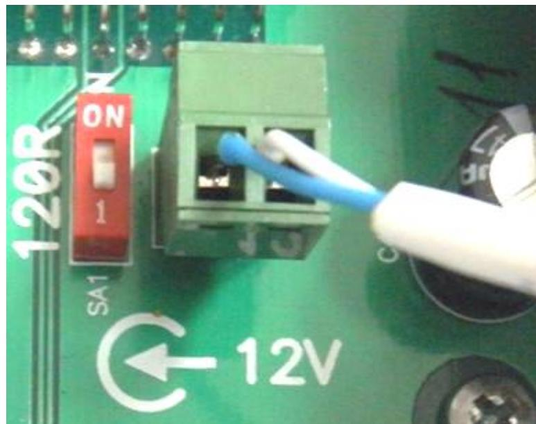
Рисунок 14.6. Подключение питания к плате УППР.
