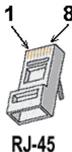
Рисунок 12.2 Нумерация выводов вилки RJ-45
