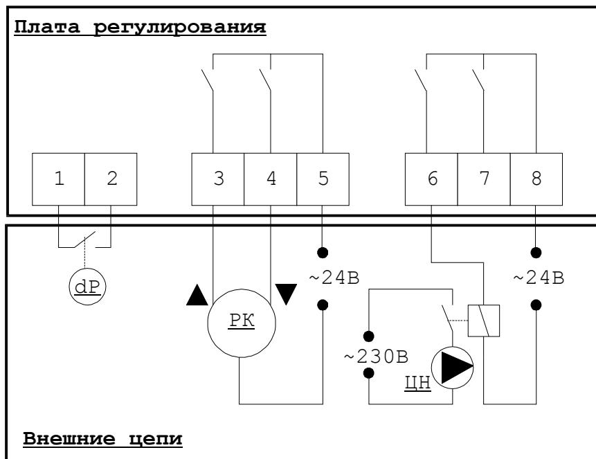
Рисунок 10.3. Схема подключения платы регулирования.
