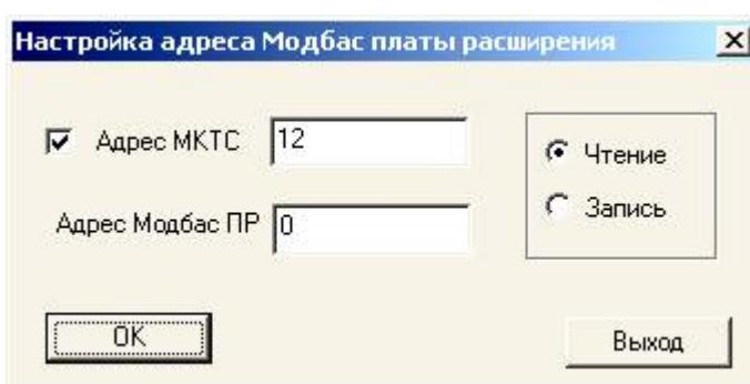
Рисунок 4.6 Настройка адреса MKTC в сети MODBUS.
