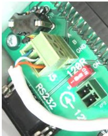
Рисунок 14.4. Подключение к УППР линии связи интерфейса RS-485
